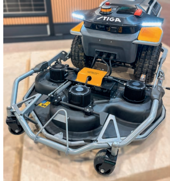
Nouveau venu dans la gamme professionnelle et présenté parmi les innovations 2025, le robot Stiga Apex Pro gère jusqu'à 27 000 m 2 grâce à ses batteries et à ses outils interchangeables. photo: Jean-Luc Pasquier
